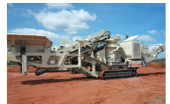
Il Lokotrack LT300HP è disponibile con alimentatore a nastro o in alternativa con alimentatore sgrassatore vibrante.
