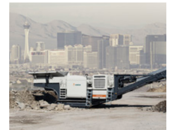
Ottenere un permesso ambientale può essere una sfida quando si processa la roccia in aree densamente popolate. Per aiutarvi ad accedere a questi luoghi, abbiamo sviluppato l'impianto di frantumazione Lokotrack® Urban™. La nuova soluzione offre fino al 60% di riduzione delle distanze di protezione dal rumore 85 dB (A) e una significativa riduzione delle emissioni polverose, consentendo operazioni di frantumazione dove necessario.
