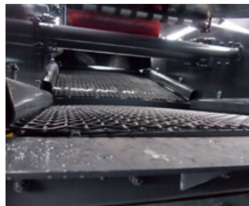
Il vaglio a doppia inclinazione consente una separazione efficiente e accurata.
